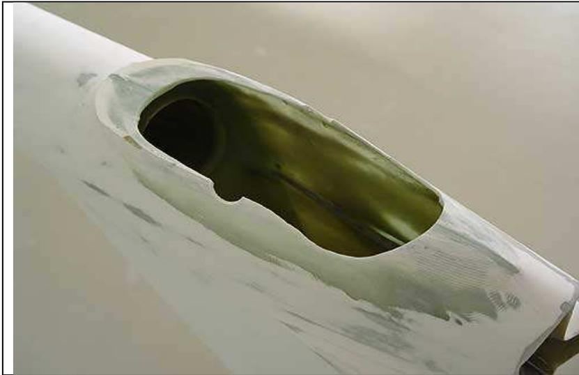
Photo n°1 : découpe du dessous de planeur pour installer le carénage
