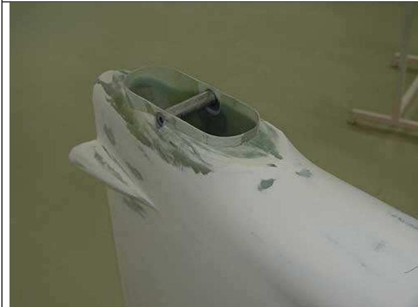
Photo n°2 : Positionnement carénage avant collage
