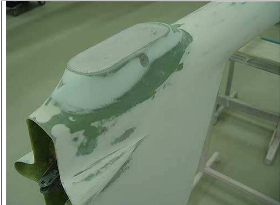
Photo n°3 : Masticage du carénage avant gelcoatage
